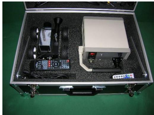
Die Inspektion eines Kanalsystems wird mit einer Kamera, die auf einem vierradangetriebenen Fahrzeug montiert ist, vorgenommen.
