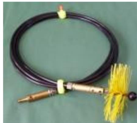
Kontrolle durch Inspektion per Video- / Bild-Aufnahme für die Dokumentation. Rohrlänge des zu reinigenden Abschnittes bis etwa 30 mtr. festlegen. Absaugventilator mit Staubsack an einer Öffnung des Rohres anschließen. Mit Bürsten / Wellen – oder Düsen/Druckluft-System von der gegenüberliegenden Seite reinigen.
